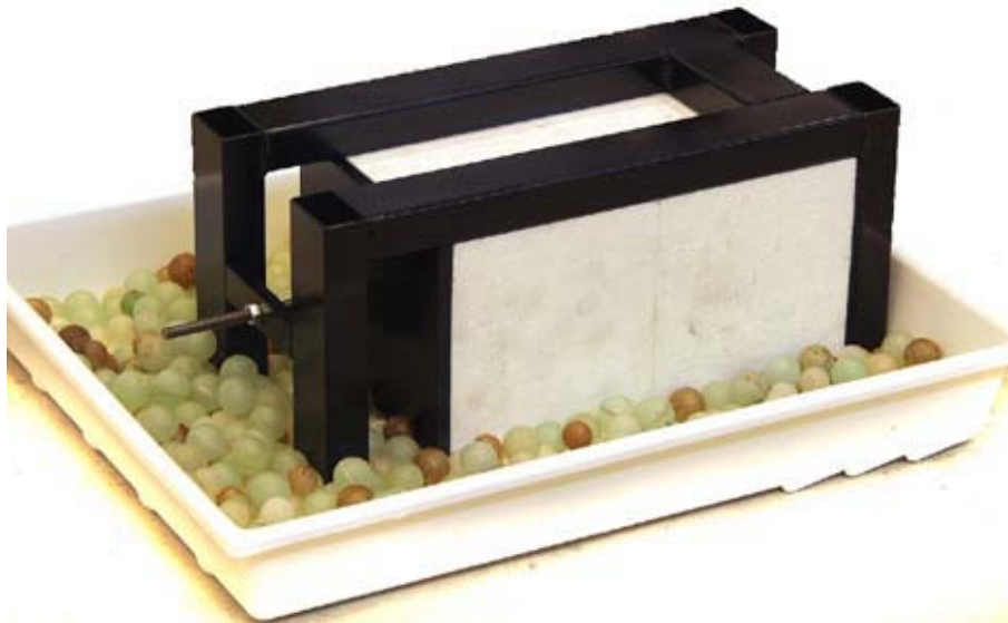
Figur 1 Forsøgsopstilling til kapillarsugning. De to lodrette, frie EPS overflader samt den vandrette, frie EPS overflade i toppen er afdækket med tyk plastfolie. Der anvendes kugler på vandet for at nedsætte fordampningen. Opstillingen afdækkes under forsøget med tyk plastfolie tapet på bakkens kant for yderligere at nedsætte fordampningen.
